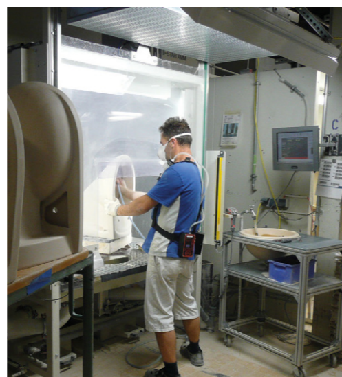
Messungen zeigen: Das Ziel, die Staubbelastung für die Beschäftigten beim Weißputzen zu reduzieren, ist voll erreicht
