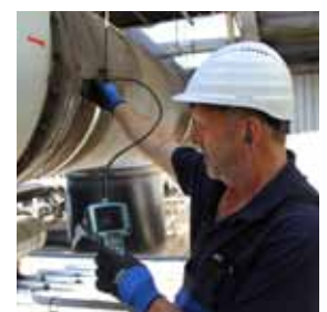
Mit Endoskopen Einblicke in das Innenleben von Rohrleitungen bekommen
