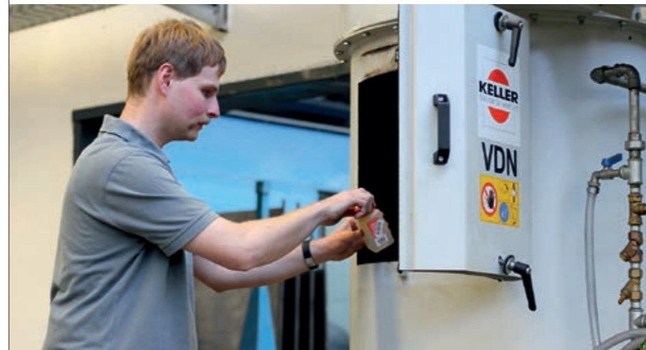
Synlab-Mitarbeiter Tim Daffner prüft die Wasser-Beschaffenheit eines Nassabscheiders
