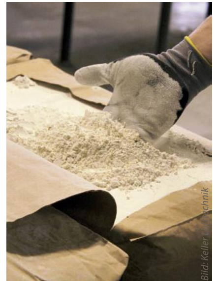
Als Filterhilfsstoff kommt Kalksteinmehl zum Einsatz
