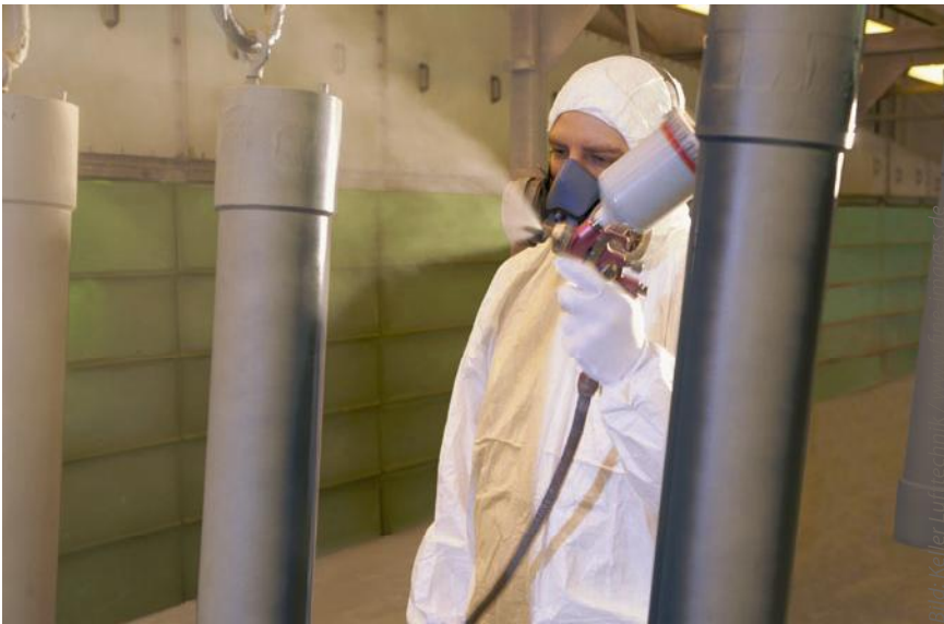
Die Erfassungselemente, die die lackpartikelhaltige Luft aus dem Lackierraum absaugen, sind in die Wand integriert
